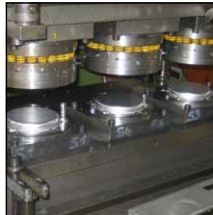
▲ 3-stufiges Lochwerkzeug 3 step perforation tool
